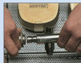
Système rapide de démontage et de montage de l'arbre d'aspersion.
