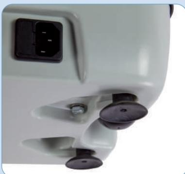
Les pieds du vibreur ont été conçus pour atténuer de manière notable la transmission des vibrations: Habituellement, les pieds du vibreur se présentent sous forme de ventouses pour qu'ils adhèrent au plan de travail ou bien sous forme de cylindres creux souples.
