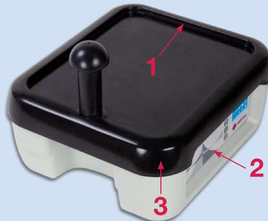
Les formes basiques du vibreur ont été conçues pour éviter que éventuels surplus de produits n'atteignent l'intérieur du vibreur. L'environnement de travail du vibreur est particulièrement sujet aux souillures. Les rebords du caoutchouc (1), le renforcement du panneau de contrôle (2), ou les arrondis des coins (3) sont des détails qui contribuent à la protection du vibreur. De plus toutes les surfaces sont planes pour faciliter son nettoyage.
