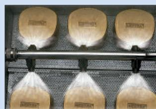
Le système de nettoyage à 6 injecteurs d'eau sous pression assure un bon ébullantage des moufles ainsi qu'un parfait décollage de la cire.
