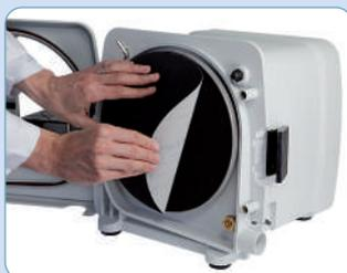
✓ Partie frontale au démontage aisé (charnière à ouverture totale). Nettoyage et accès au disque faciles.
