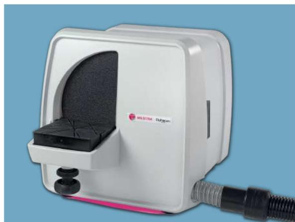
La principale caractéristique du taille-plâtre est que l'opération de surfacage se fait à sec.
