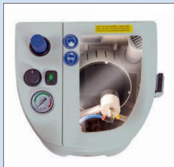
Les squelettes se placent dans un panier tournant grâce à l'action d'un moteur.
