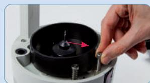
Les détails sont très importants dans la conception de la foreuse Atlas: le système de fixation de la fraise doit être facile à libérer. La perforeuse Atlas permet de la libérer en quelques secondes pour pouvoir la remplacer ou en ajuster la hauteur.
