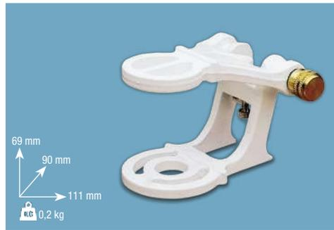
L'ajustage de cet articulateur se fait grâce à des butées coniques. L'une fixe, l'autre amovible, ce qui évite du jeu provoqué par une utilisation intensive.
