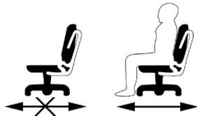
La silla incorpora un sistema de frenado de seguridad. Cuando no hay nadie sentado las ruedas se bloquean para evitar que la silla se mueva accidentalmente. Cuando alguien se sienta, las ruedas se desbloquean y giran libremente.
