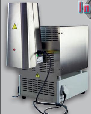
Sencillo dispositivo que se acopla a la salida de humos de cualquier horno de precalentamiento para eliminar los gases y productos inquemados que se generan en el horno como consecuencia de la combustión de las ceras y otros materiales.
