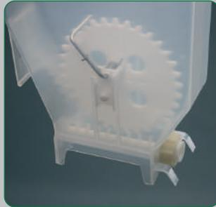
En caso de desgaste u obstrucción del husillo dosificador, es posible desmontarlo y sustituirlo en menos de dos minutos, sin que se requiera ningún tipo de conocimiento mecánico ni ninguna herramienta. Bastan las manos.
