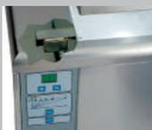
Durante el funcionamiento de la máquina la puerta de la cabina permanece bloqueada por un cierre de seguridad que evita posibles accidentes.
