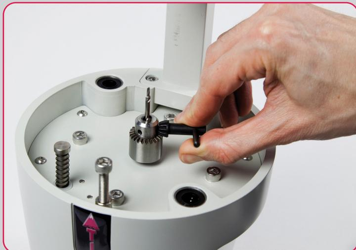
Un autre détail important est la souplesse de manœuvre. Contrairement à d'autres machines, la perforatrice à pins **Atlas** est dotée d'une table guidée par des paliers axiaux et des ressorts. Le résultat est surprenant: le toucher est ferme et précis, sans aucun jeu avec une résistance et une souplesse justes, pour un glissement libre et sans à-coups, une caractéristique difficile à trouver sur d'autres machines similaires.
