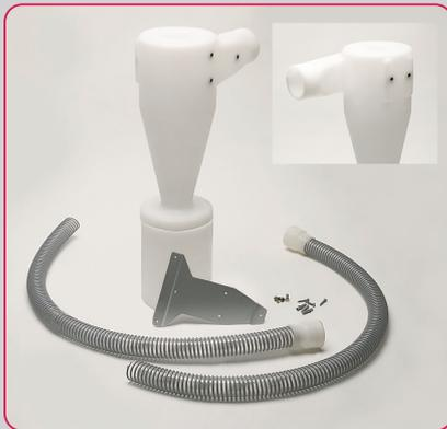
La instalación del aparato es muy sencilla. Basta con fijarlo mediante tres tornillos a cualquier pared o soporte. La orientación del tubo de entrada puede ser a derechas o izquierdas. El aparato se suministra con todos los accesorios necesarios para su montaje: mangueras de conexión; adaptadores de entrada; chapa soporte; tornillos de fijación.
