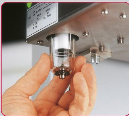
La batidora de vacío **Koala** cuenta con un filtro neumático tipo cartucho de alta eficiencia, que protege a los elementos mecánicos del polvo y la suciedad.
