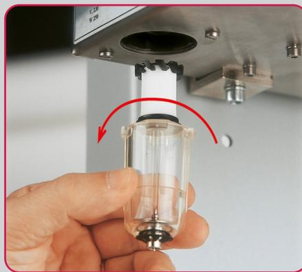
La sustitución o limpieza del elemento filtrante resulta sencilla. El acceso es inmediato, y no es necesario desmontar la máquina o emplear ningún tipo de herramienta.
