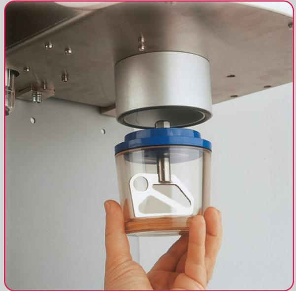
La batidora de vacío **Koala** cuenta una con las gamas de tazas de batido más amplia del mercado, con capacidades de 250 cc.; 550 cc.; 750 cc.; 1.000 c.c.; 1.250 c.c.; y 230 cc. (especialmente diseñada para batido de alginatos), todas ellas fabricadas en policarbonato transparente de alta resistencia.
