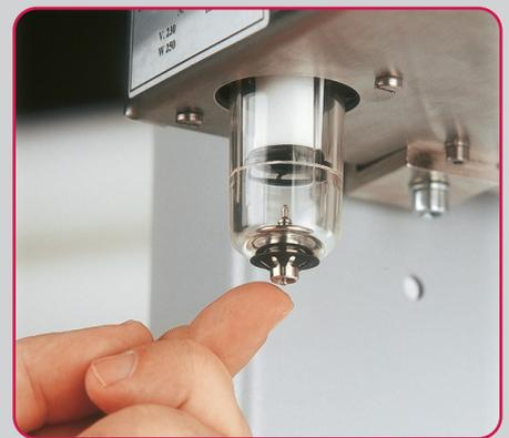
En caso de parada de la batidora de vacío por corte en la red de suministro eléctrico, es posible soltar la taza del cuerpo de la batidora (maniobra de emergencia), actuando manualmente sobre la válvula de descarga situada en la carcasa del filtro.
