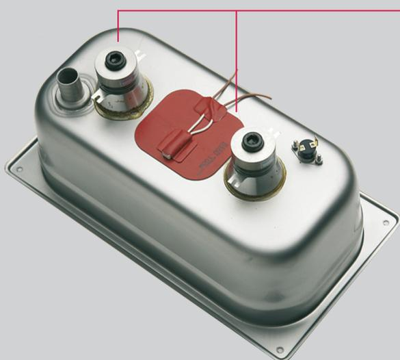
Le bac dispose de deux puissants transducteurs type «sandwich» transmettant 100 w. Sa fréquence de travail (40Khz) offre un compromis optimal entre le bruit et l'efficacité de nettoyage.
