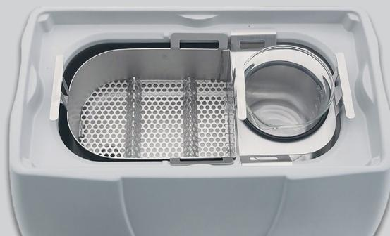
La cuve de 4 litres, permet différentes configurations: cuve nue; petit panier pour instrumentation; ou bocal en verre de type pyrex avec son support pour le nettoyage de petits objets.
