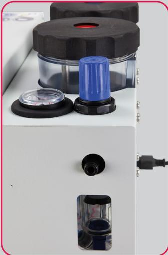
En cuanto al mantenimiento del aparato, todo el sistema de soplado puede desmontarse de manera rápida, sencilla y sin herramientas para solucionar pequeñas obstrucciones.
