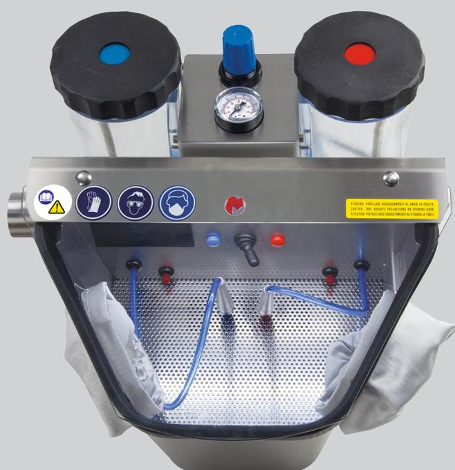
La válvula de cambio de vaso está situada en el interior de la cámara. El criterio de colores permite identificar y seleccionar rápidamente el vaso deseado. Para el ajuste inicial del chorro puede emplearse una sufridera de goma también situada en el interior de la cámara.
