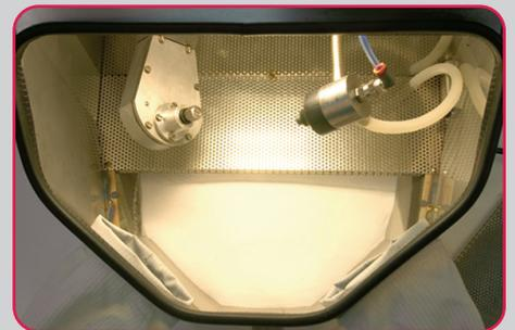
Le sable est stocké dans la trémie de la machine est absorbé par l'aspiration Venturi et enfin injecté par la buse. Il revient ensuite dans la trémie.
