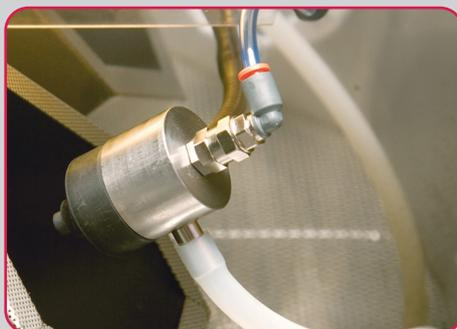
Le débit de sable parcourt un circuit fermé stimulé par un système pneumatique de type Venturi.
