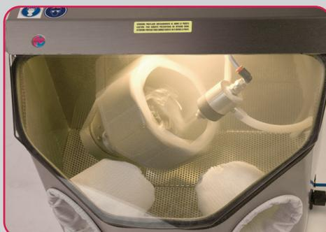
Les squelettés se déposent dans un panier qui tourne par l'action d'un moteur.
