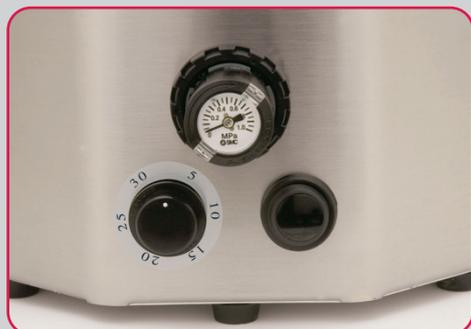
Les commandes de la machines ont été simplifié au maximum pour permettre un usage facile: un bouton pour le soufflage manuel; un bouton pour le temporisateur; et un manorégulateur qui comprend son propre manomètre, pour connaître à tout moment la pression de soufflage.
