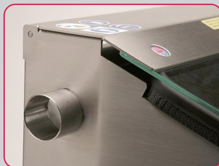
La sortie de poussière à l'intérieur de la chambre se réalise à l'aide d'un tuyau situé sur la partie latérale de la machine, auquel on peut accoupler tout type d'unité d'aspiration conventionnelle. (Conçue pour le travail avec l'oxyde d'aluminium).
