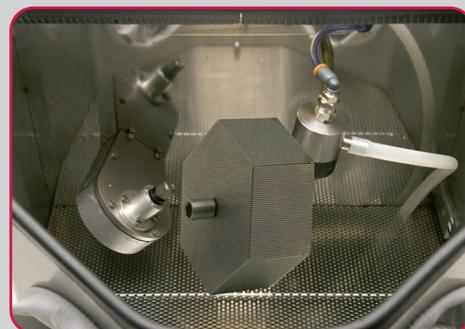
Le panier peut se détacher de l'axe moteur avec facilité ce qui simplifie la préparation des travaux.
