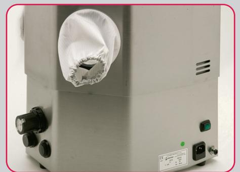
Les manchons de protections permettent la fermeture de la chambre de travail lors des travaux de sablage évitant ainsi les fuites de sables.
