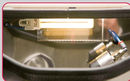
La iluminación se realiza a través de una potente lámpara fluorescente que ofrece una fiel reproducción cromática sin brillos. La lámpara se encuentra protegida contra las proyecciones de arena por un escudo de policarbonato transparente.
