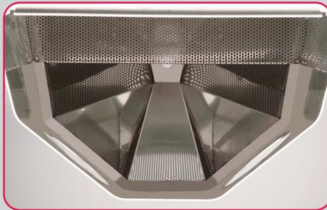
La tolva-depósito de arena tiene una capacidad de hasta 12 kg de arena. Este volumen, junto con su acusada profundidad y los empinados ángulos de caída, permiten el funcionamiento totalmente automático de la máquina durante más de 30 minutos.
