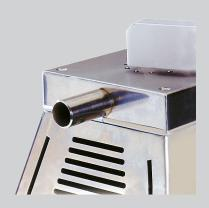
Un tube placé dans la partie postérieure de la table de travail permet l'èvacuation de la production de poussières.
