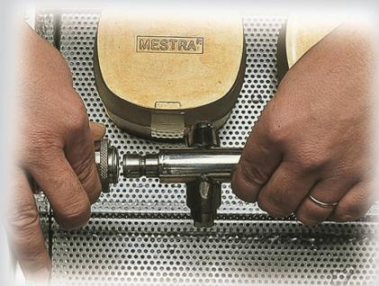
Système rapide de démontage et de montage de l'arbre d'aspersion.
