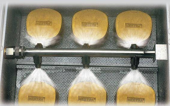
Le système de nettoyage à 6 injecteurs d'eau sous pression assurent un bon ébouillantage des moufles ainsi qu'un parfait décollement de la cire.
