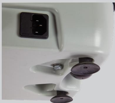
Les pieds représentent également une avancée dans la transmission des vibrations sur la paillasse du plâtre. Traditionnellement les pieds d'un vibreur étaient des ventouses pour obtenir une fixation de celui-ci au plan de travail; ou bien des pivots creux très flexibles.
