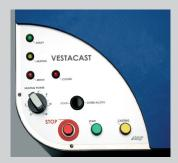
Ce panneau de contrôle est de type synoptique permettant une utilisation très intuitive. Trois boutons de commande et un potentiomètre grâce auquel on règle la puissance de la coulée suffisent à réaliser la coulée. La température de fusion peut atteindre les 1750°C. Les étapes du processus est visualisé grâce à 4 lampes témoin.
