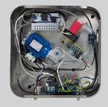
Les composants utilisés, de premier choix, sont montés en modules autonomes. Grâce à cette logique d'assemblage, l'entretien devient très aisé. Il suffit de démonter le module endommagé et de le remplacer par un autre. Cette opération peut être menée par n'importe quel service technique avec un prix modéré.
