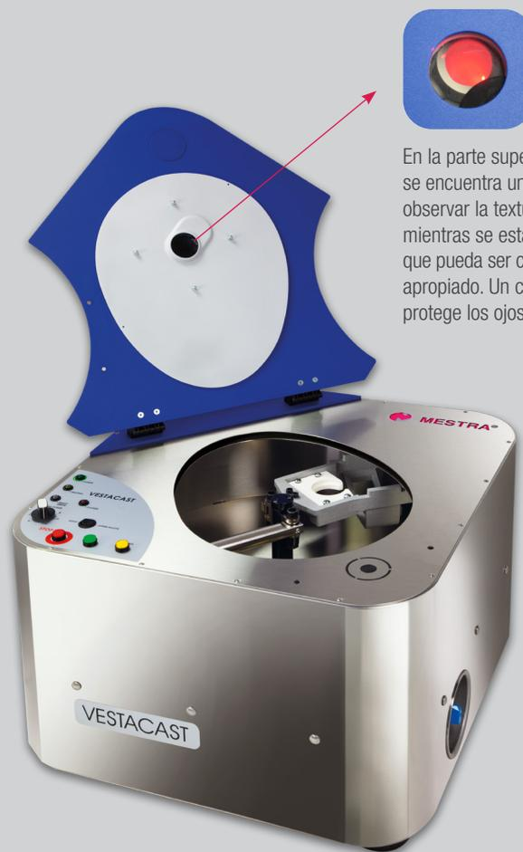
En la parte superior de la máquina se encuentra una mirilla que permite observar la textura de la aleación mientras se está fundiendo, para que pueda ser colada en el momento apropiado. Un cristal con filtro UV protege los ojos durante la visión.
