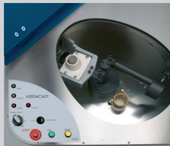
El acceso al interior es amplio y cómodo debido a la generosa ventana superior. El brazo es de tipo auto-expandible con muelles de recuperación, lo que permite alcanzar una aceleración centrífuga máxima en el arranque de la máquina. La ligereza del brazo reduce en gran medida las vibraciones características de este tipo de aparatos.
