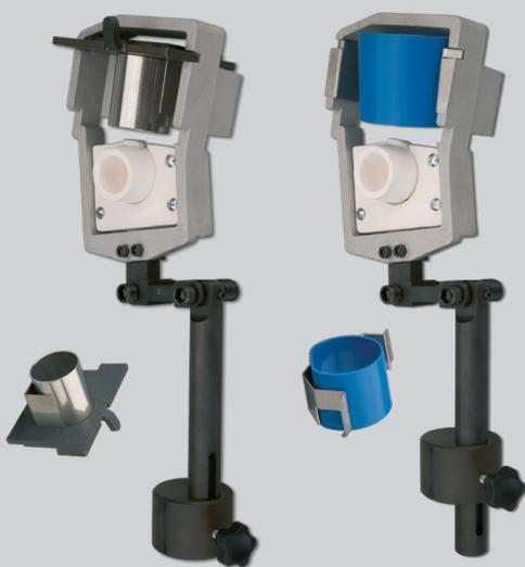
El equilibrado del brazo se simplifica mediante el uso de portacilindros compensados por peso para cada diámetro de cilindro. Por medio de este sistema se eliminan las regulaciones, consiguiéndose siempre un perfecto reparto de masas con independencia del tamaño del cilindro empleado.
