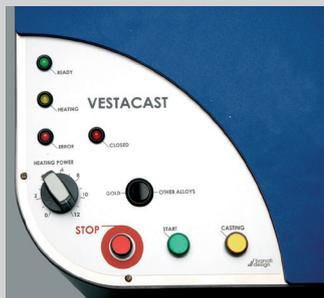
El cuadro de control es de tipo sinóptico permitiendo un manejo intuitivo. Tres botones de mando y un potenciómetro con el que se regula la potencia de fundido, son suficientes para realizar el colado. La temperatura de fusión puede llegar a alcanzar los 1750 °C. El estado del proceso se visualiza a través de cuatro lamparitas indicadoras.
