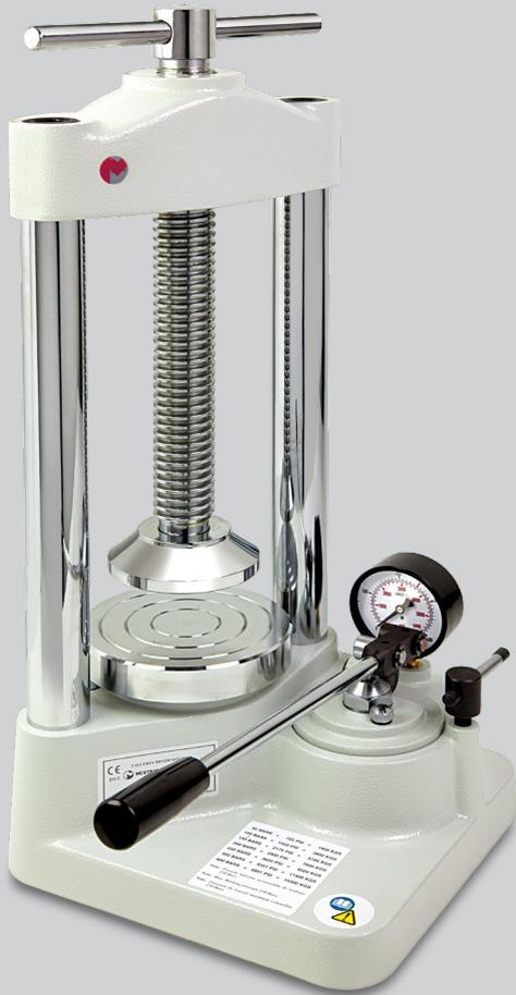
Les nouvelles techniques appliquées au traitement de l'aluminium ne sont pas seulement réservées à l'aéronautique ni à l'automobile. **MESTRA** s'est servi de ces techniques pour la construction de la presse hydraulique de laboratoire. Le pont et la base de la presse sont entièrement fabriqués en aluminium, fondu et ayant subi un traitement thermique, ce qui améliore indiscutablement le rendement et la durée de vie de la machine par rapport à une presse traditionnelle.
