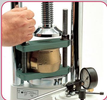
La largeur entre les colonnes et le diamètre du plateau supérieur, permettent d'introduire ou d'enlever les moufles avec la bride **MESTRA** Réf. 030380-90-400-410, et ce, sans être obligé de remonter l'axe vissant, d'où gain de temps et de gestes in nécessaires.
