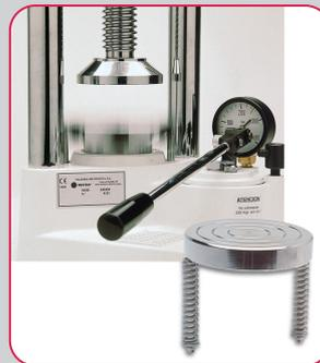
Système de récupération du plateau inférieur. En libérant le système hydraulique de pression, le plateau inférieur revient à sa position initiale.
