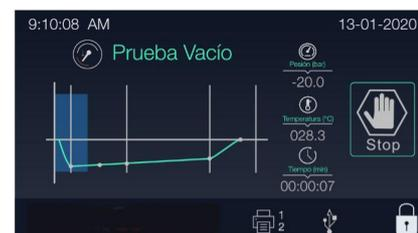
está por encima de 3° C, se mostrará "void". Eso significa que el resultado de la prueba es fallido. Debe ejecutar la prueba de vacío nuevamente después de que la cámara se haya enfriado.
