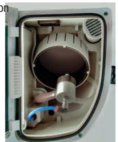
La buse de la sableuse est orientable dans tous les sens ce qui permet au technicien de trouver l'angle de sablage souhaité.
