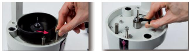
Les détails sont très importants dans la conception de la foreuse Atlas: le système de fixation de la fraise doit être facile à libérer. La perforatrice Atlas permet de la libérer en quelques secondes pour pouvoir la remplacer ou en ajuster la hauteur. D'autre part, la table permet de faire un réglage très simple de la profondeur de fraisage. Il suffit de tourner une vis pour pouvoir l'ajuster à la hauteur souhaitée.
