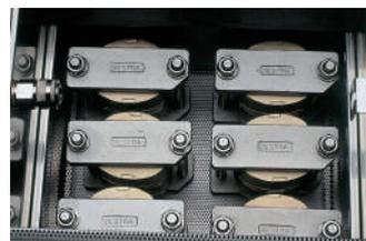
La capacité de la cuve permet d'introduire jusqu'à 6 brides de 2 mouffles.
