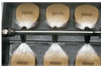
Le système de nettoyage à 6 injecteurs d'eau sous pression assure un bon ébullantage des mouffles ainsi qu'un parfait décollement de la cire.
