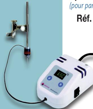
Avec une tige de fixation de 3, 2,35 ou 2 mm de diamètre (préciser le diamètre lors de la commande). Insertion idéale sur un paralléliseur, une fraiseuse ou dérivé pour modeler la cire sur les modèles. La spatule est fournie avec un assortiment de pointes et avec un boîtier de contrôle électronique qui permet de régler très précisément la température de travail, indiquée sur le display digital.
