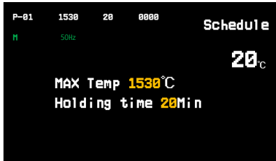
► P-01 ~ 03, 09 : Establezca la temperatura máxima y el tiempo de mantenimiento.
