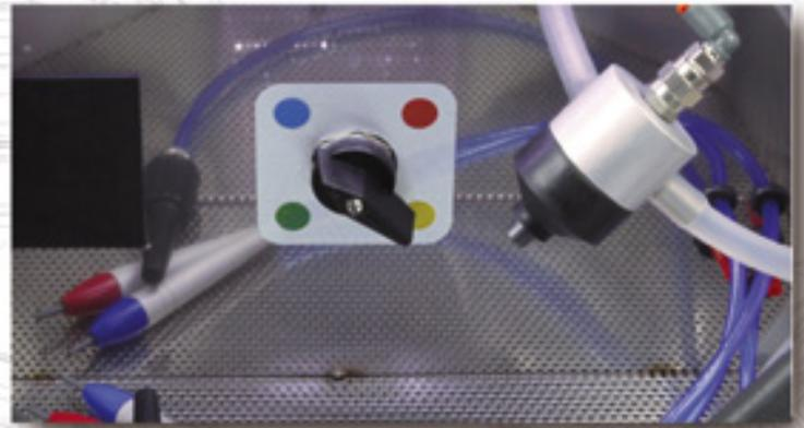
La válvula de cambio de vaso está situada en el interior de la cámara. El criterio de colores permite identificar y seleccionar rápidamente el vaso deseado. Para el ajuste inicial del chorro puede emplearse una sufridera de goma también situada en el interior de la cámara.
