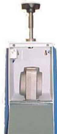
(Fig. 2) L'axe de serrage doit rester complètement élevé lors de l'extraction de la moufle
