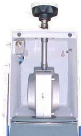
(Fig. 1) Detalle colocación de la mufla
