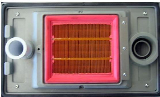
3. Coloque el nuevo filtro cartucho, y proceda a montar el resto de componentes.
