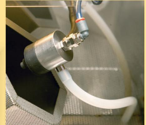
El caudal de arena recorre un circuito cerrado impulsada por un sistema neumático de tipo Venturi.
