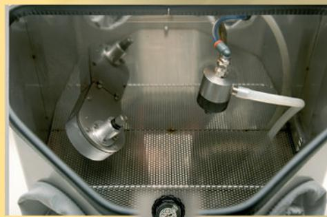
La arenadora con Pistola Estática Galaxy dispone de un botón para el soplado manual. De esta manera, -y orientando adecuadamente la boquilla- se facilitan los pequeños retoques de las piezas después del arenado automático.
