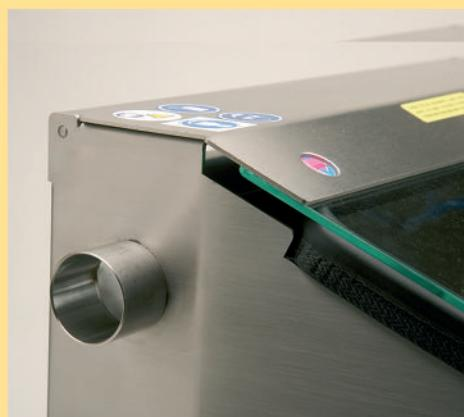
La salida de polvo del interior de la cámara se realiza a través de un tubo situado en la parte lateral de la máquina, al que puede acoplarse cualquier unidad de aspiración convencional. (Preparada para trabajar con Óxido de Aluminio).
