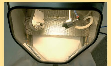
La arena almacenada en la tolva de la máquina es absorbida por la aspiración del Venturi y luego es inyectada a presión por la boquilla. Posteriormente vuelve a caer otra vez en la tolva.
