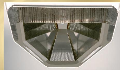
La tolva-depósito de arena tiene una capacidad de hasta 12 Kgr. de arena. Este volumen, junto con su acusada profundidad y los empinados ángulos de caída, permiten el funcionamiento totalmente automático de la máquina durante más de 30 minutos.
