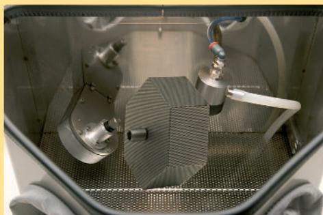
La cesta puede desacoplarse del eje motor con facilidad, lo que simplifica la preparación de los trabajos.
