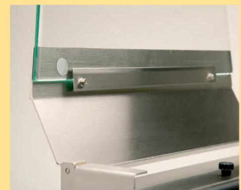
El cristal tiene un recubrimiento especial que actúa de protección superficial. Este recubrimiento reduce el efecto abrasivo de la arena y evita accidentes en caso de rotura. La sustitución de cristal es muy sencilla.
