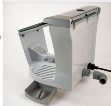
Mención aparte merece su sistema de recogida de polvo. La boca de aspiración está situada en un lugar estratégico en el que no estorba. La boca se conecta a una aspiración externa por la parte trasera mediante una toma orientable. Además, unos cajones desmontables recogen el polvo que pudiera caer a través de los reposamanos. Hablamos de un ingenioso sistema que mantiene limpio el interior de la cámara haciendo más agradable el trabajo.
