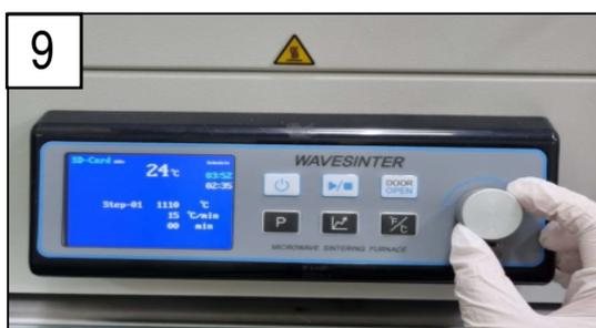
Tourner le dial ⑦ pour modifier la vitesse de montée (°C/min).
