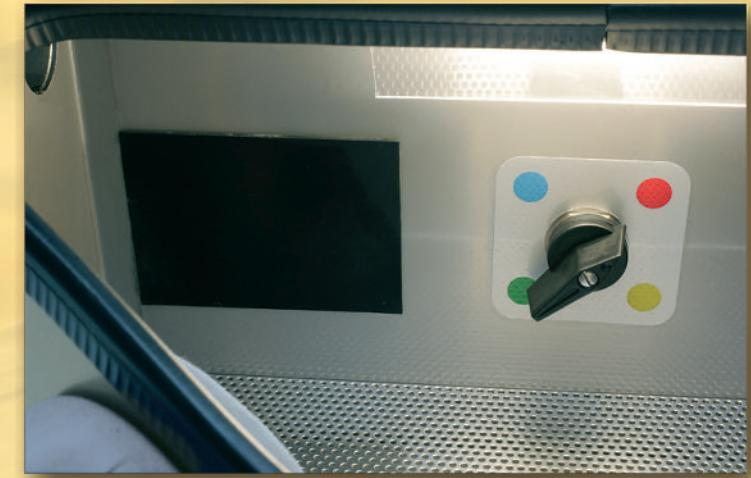
La válvula de cambio de vaso está situada en el interior de la cámara. El criterio de colores permite identificar y seleccionar rápidamente el vaso deseado. Para el ajuste inicial del chorro puede emplearse una sufridera de goma también situada en el interior de la cámara.
