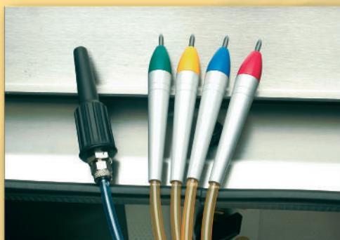
Las pistolas de arenado pueden identificarse fácilmente mediante un sistema de colores. Así se conoce en todo momento el grosor de la arena empleada. Todos los modelos Constellation cuentan también con una pistola de soplado.
