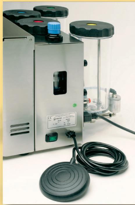
Una ventana situada en un lateral de la máquina permite ver el nivel de condensados en el filtro. La purga de líquidos se realiza automáticamente. El pedal de la máquina es de tipo neumático: ligero, de suave accionamiento, tubo muy flexible; y de fácil colocación.
