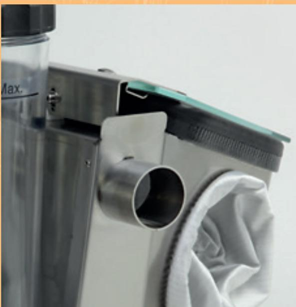
La salida de polvo del interior de la cámara se realiza a través de un tubo situado en la parte lateral de la máquina, al que puede acoplarse cualquier unidad de aspiración convencional. Preparada para trabajar con óxido de silicio. **MESTRA** recomienda las referencias **R-080532 Eolo plus** o **R-080539 Gemini**.
