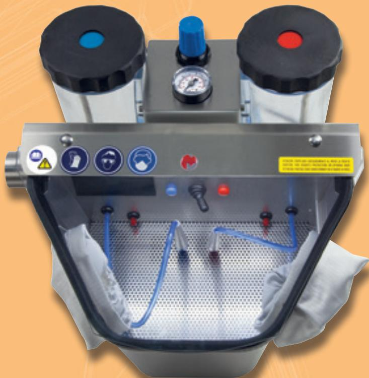
La válvula de cambio de vaso está situada en el interior de la cámara. El criterio de colores permite identificar y seleccionar rápidamente el vaso deseado. Para el ajuste inicial del chorro puede emplearse una sufridera de goma también situada en el interior de la cámara.
